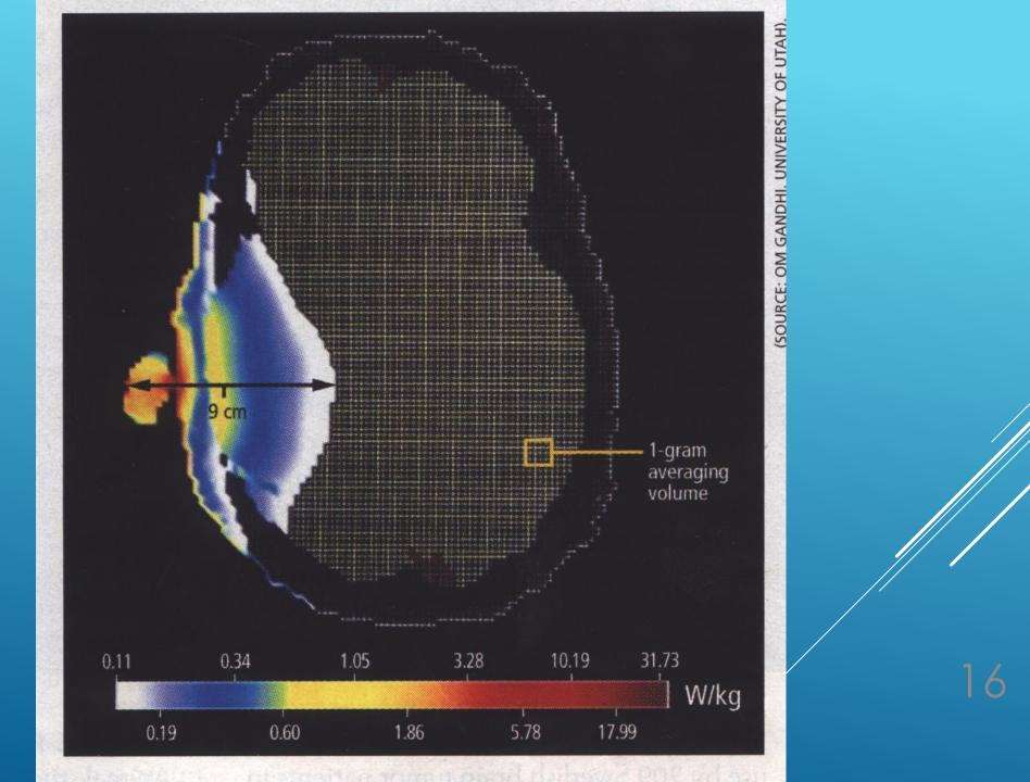
Gandhi O.P., Lazzi G., Furse C.M. (1996 vol.44, p1884-1897) : Absorption des rayonnements électromagnétiques dans la tête et le cou humain pour les téléphones mobiles de 835MHz /1900MHz
